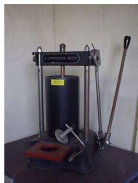
821 手動ハンバーグ成形機 (スタッパー) (写真は同型の「820」)
