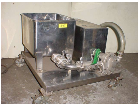
847 液体移送ポンプ
