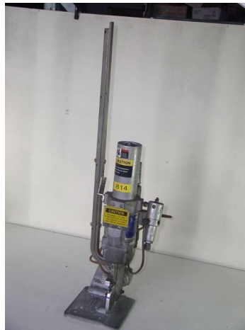
821 手動ハンバーグ成形機 (スタッパー) (写真は同型の「820」)
